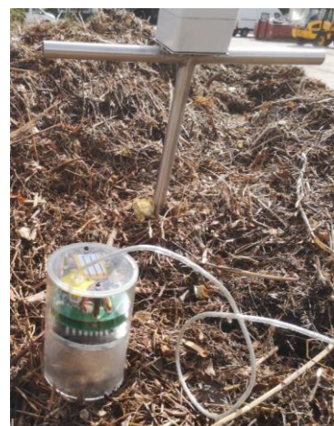
Temperaturmesslanze (Hintergrund) und Funktionsmuster zur Gasmessung (Vordergrund) mit integrierter Sensorik
