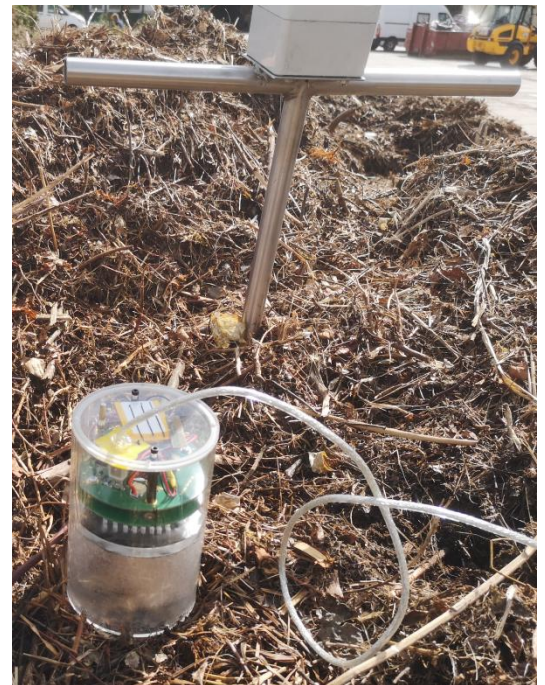
Die Abbildung zeigt die im Projekt entwickelte Temperaturmesslanze (Hintergrund) während der Praxisdemonstration und das entwickelte Funktionsmuster einer Gassensorik (Vordergrund) in einem Praxisversuch
