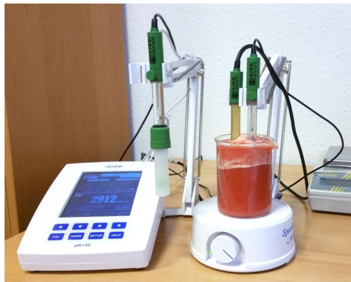
Messung von pH-Wert, Redoxpotenzial und Leitfähigkeit mit der Standard-Laboranalyse an Tomatensaft
