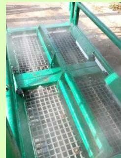
Reinigungsdüsen in Betrieb
