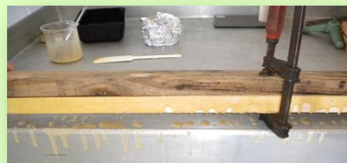
Verkleben der Holzblöcke miteinander bei definierter Aushärtungsdauer und Temperatur
