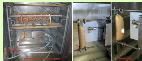
prototypischer Versuchsstand in der Räucheranlage (Labormaßstab), (Bildquellen: FH Anhalt)
