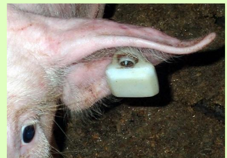
Neu entwickeltes Gehäuse mit Sensortechnik zur kontinuierlichen Erfassung der Temperatur und Aktivität am Schweineohr
