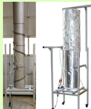
Trocknungsturm mit innen STIR®-beschichteten Edelstahlrohr und Rohrheizkörper außen/links vor Isolierung, rechts nach Isolierung
