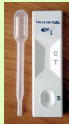
Funktionsmuster des Streifentests mit Applikationspipette
